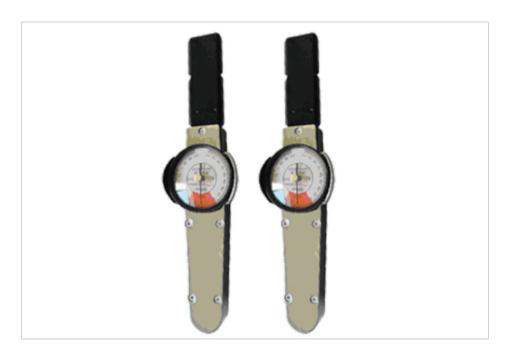
否则会导致扭矩误差增加。也不能在施力过程中忽慢忽快。其次,力的方向。保持扭矩扳手与紧固件垂直是操作人员施力过程中掌握的基本要求。另外,在施力过程中,前后、左右方向不能超过15°。\*\*\*,力的作用点。在施力过程中,操作人员应观察扳手柄上的有效线,观察是否握住其有效线。不能私自在扳手手柄上加套管,否则会增加扭矩误差。如图1所示。图1扭矩扳手使用图二、扳手的选用扳手选用时,应综合考虑以下因素: \*\*\*,头部选择。结合使用控制点的工况选择开口头、梅花头等扭矩扳手。一般而言,棘轮式的扳手是比较好选择。究其原因是棘轮式扳手的安全性较高,且使用时较为便利。与此同时,棘轮式扳手是标准件,造价成本低。第二,扳手的量程。比较好选择设定值在扭矩扳手量程二分之一的扳手。第三,长度和重量。在具体使用中,比较好选择长度较长的扳手。不易选择重量大的扳手。究其原因是重量大的扳手会增加劳动者强度,从而降低工作效率。上海海塔与您分享力矩扳手对如今市场的影响。德国多功能力矩扳手性价比
